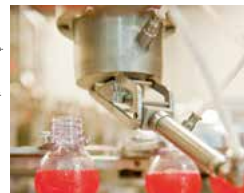
Die vollen Flaschen werden in einem LinCool Flaschendurchschüttler auf Umgebungstemperatur heruntergekühlt.
