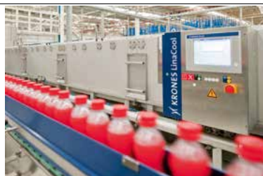
Die vollen Flaschen werden in einem LinCool Flaschendurchschüttler auf Umgebungstemperatur heruntergekühlt.
